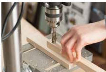
材料Aをサイズにカットしたら、図のように上下に竹用ドリル12mmで、9mmの深さの座掘りをする。次に中心に3mmの深さで座掘りをしたところに5mmの貫通穴をあける。座掘りをするときは、正確に深さを決めることができる卓上ボール盤を使うと便利。穴あけをしたら、サンダーなどで面取りをし、両端の角を丸みが出るように削る。
