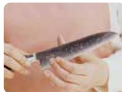
まず右側にあたる面の刃から研ぎ始めます。研いでいくと刃先にバリ(刃返り・返り・まくれ)がでてきますので、全体のバリを確認しながら研ぎ作業を進めます。
