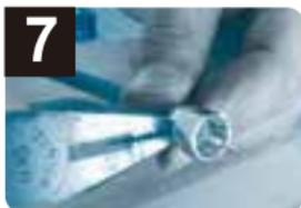
**7** **[F型コネクタ]**をねじ込んだ部分を押さえるように、**[ベンチ]**でリングをつぶして固定します。
