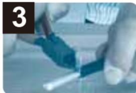
**3** 網状の金属線を広げ、**[ニッパー]**でカットし、皮膜を露出させます。
