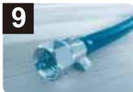
**9** **[F型コネクタ]**の取り付けが完成です。**8**でのカットの際、切り口を少し斜めにしておくと器具への取り付けが楽になります。
